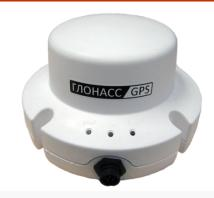
DMR-800L с ГЛОНАСС/GPS является терминалом спутниковой передачи данных со встроенным приемником ГЛОНАСС. Разработанный специально для Российского рынка телематики, этот терминал рассчитывает местонахождение с помощью любой из навигационных систем.
